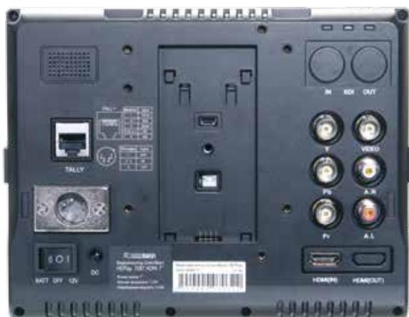
Профессиональный видеомонитор с высококачественной IPS матрицей диагональю 7" и разрешением 1280x800. Высокая контрастность и яркость, широкие углы обзора - 89°/89°(вверх/вниз), 89°/89°(слева/справа). Интерфейсы HDMI, YPbPr, AV. Встроенный динамик и разъем для наушников.
