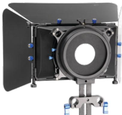
Компендиум Matte Box 02 имеет два фильтродержателя, один из которых может вращаться при работе с поляризационными или цветными фильтрами размером 10x10 см, второй (не вращающийся) позволяет использовать фильтры размером до 10x11,2 см. Компендиум крепится к рельсовым направляющим рига и имеет возможность регулировки по высоте в пределах 70 мм. В комплекте 5 резиновых колец для сопряжения с объективами разных диаметров.
