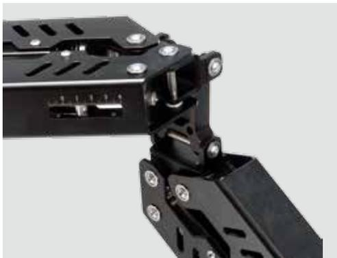
Шарнирные узлы с подшипниковыми опорами обеспечивают высокую точность движения и отсутствие люфтов. Все узлы изготовлены из высокопрочного алюминиевого сплава. Двухсекционная механическая рука с двумя независимо регулируемым пружинами в каждой секции, для балансировки и точной настройки.
