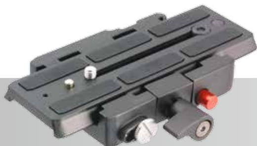
Предназначен для создания посадочного места типа «быстросъемная площадка» на риге, слайдере, обычной штативной голове, носимых стабилизаторах камер, кронштейнах. Имеет два пузырьковых уровня для выставления камеры в горизонт. Адаптер состоит из базы и подвижной площадки. База имеет пять резьбовых отверстий 1/4 дюйма и одно отверстие 3/8 дюйма — для крепления к несущей опоре.
