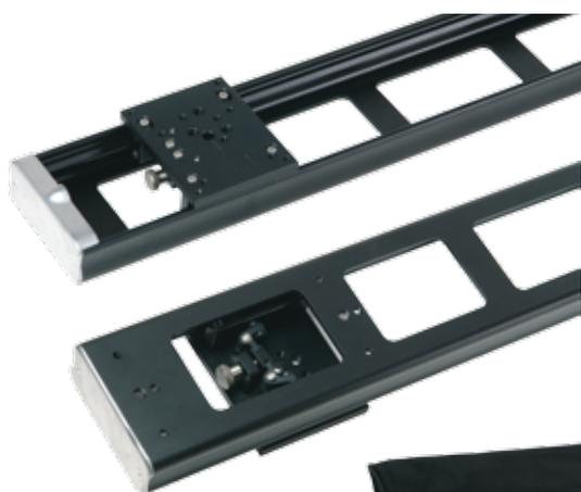
Слайдеры для тяжелых условий эксплуатации и профессионального использования в кинопроизводстве. Каретка с механизмом выборки зазора и металлическими подшипниками гарантирует безлюфтовый ход и продолжительное использование с камерами весом до 20 кг. В комплекте поставляются съемные ноги с зубчатыми муфтами, отдельно приобретается адаптер с "чашей" для установки профессиональных видеоголовок с полусферическим основанием.
