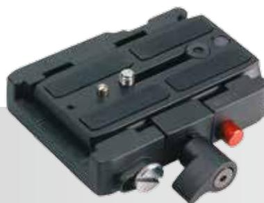
Предназначен для создания посадочного места типа «быстросъемная площадка» на риге, слайдере, обычной штативной голове, носимых стабилизаторах камер, кронштейнах. Имеет два пузырьковых уровня для выставления камеры в горизонт. Адаптер состоит из базы и подвижной площадки. База имеет пять резьбовых отверстий 1/4 дюйма и одно отверстие 3/8 дюйма — для крепления к несущей опоре.
