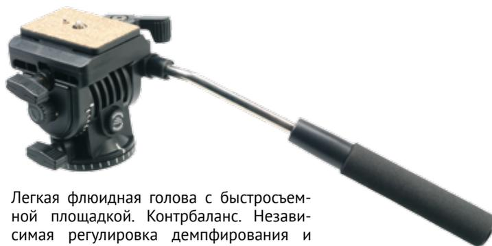
Легкая флюидная голова с быстросъемной площадкой. Контрбаланс. Независимая регулировка демпфирования и фиксации наклона и поворота, крепление 3/8", нагрузка до 3 кг. Материал - ABS пластик, алюминивно-магниевый сплав.
